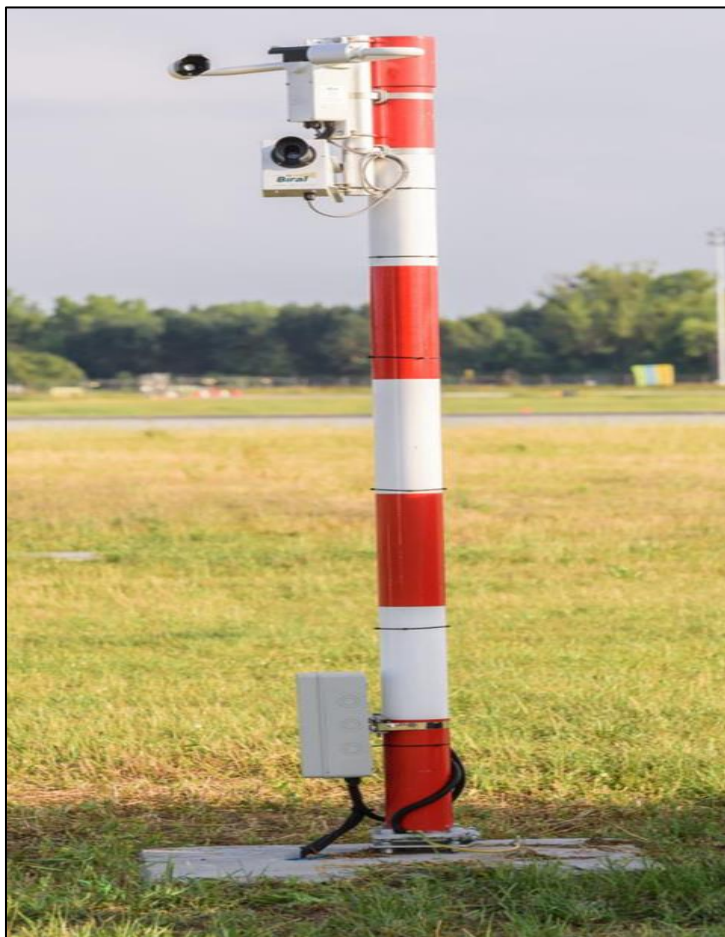
Widzialnościomierz Biral SWS-050 z czujnikiem oświetlenia tła
